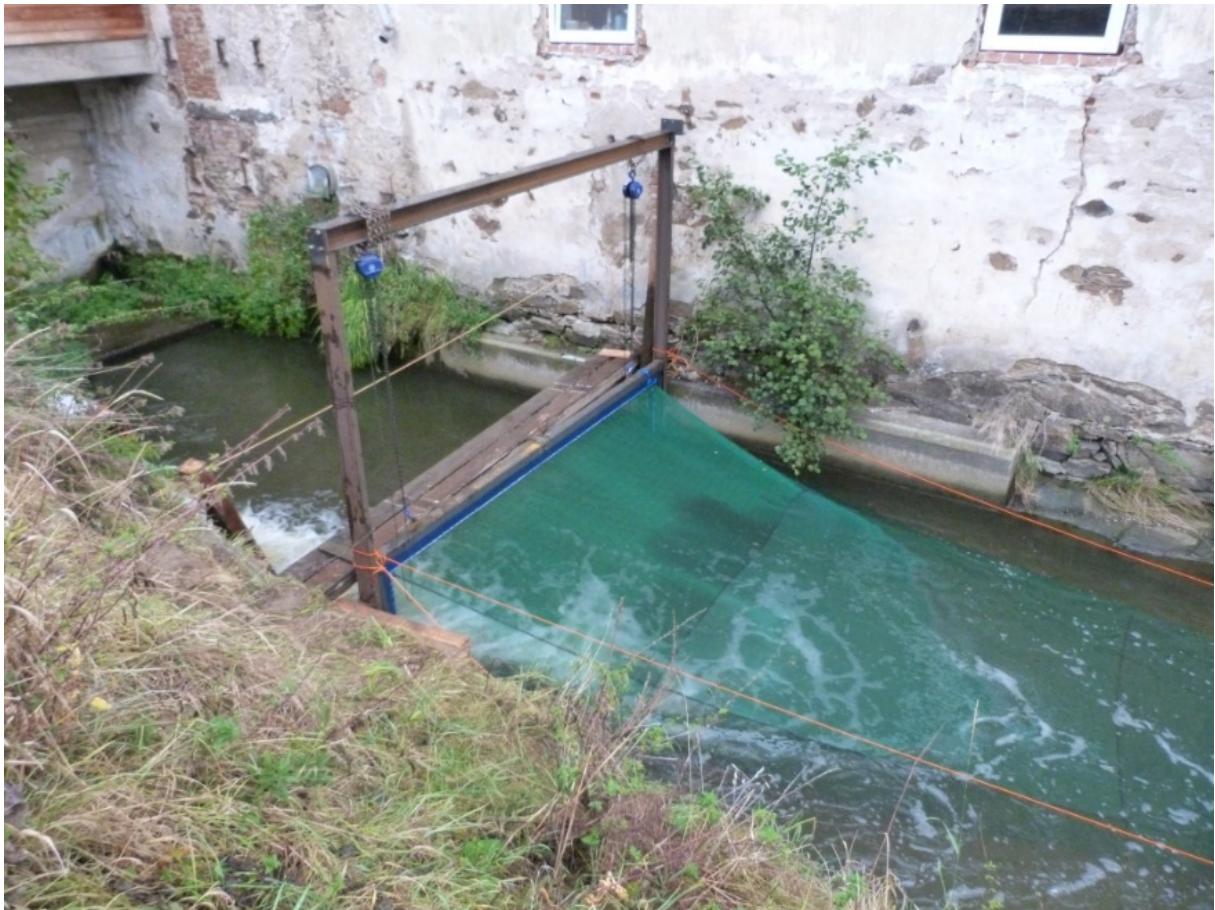
Abbildung 52: Exponierter Hamen im Unterwasser direkt nach dem Turbinenauslass.
