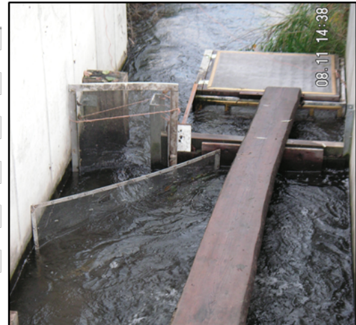
Abbildung 46: Monitoringdaten zur Untersuchung des Fischabstiegs an der FAH mittels Abstiegsreuse (links) und Abbildung der Abstiegsreuse (rechts).
