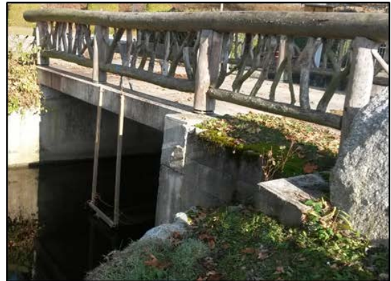
Abbildung 51: Monitoringdaten zur Untersuchung der Abwärtswanderung im Triebwasserkanal mittels Driftnetz (links) und Abbildung der montierten Driftnetze (rechts).
