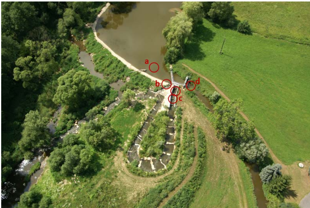
Abbildung 42: Lage der Monitoringeinrichtungen im Frühjahr und Frühsommer 2016. a) Driftnetze Staubereich, b) Netz Wehrdotation, c) FAH: Reuse und Driftnetz, d) Driftnetze Triebwasserkanal
