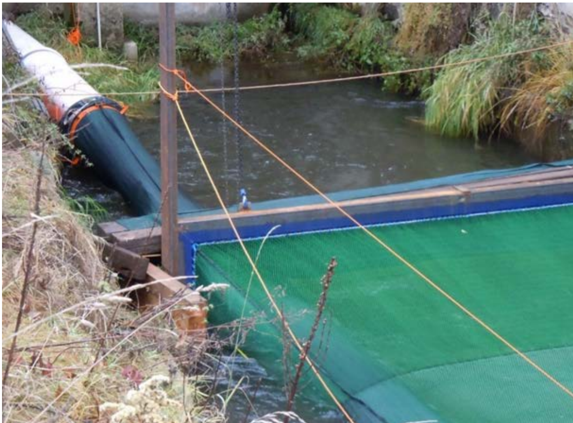
Abbildung 21: Fangsack am Bypassrohr montiert (im Vordergrund: Netze zur Beprobung der Turbinenpassage).
