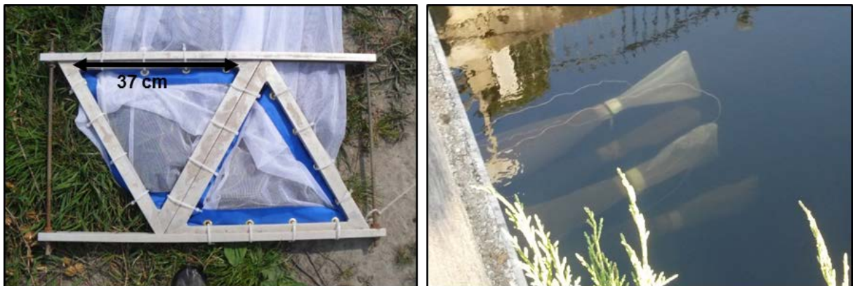
Abbildung 16: links: Metallrahmen (Öffnung) eines Doppel-Driftnetzes. rechts: durch Reißverschluss abnehmbare Fangsäcke am Ende des 5 m langen Netzes.
