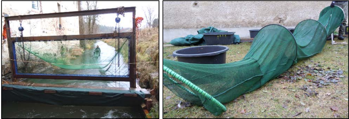
Abbildung 22: Gerüst und montierter Hamen im Unterwasserkanal mit Blick flussab; rechts: Steert am Ende des Hamens mit Verstärkungsringen.
